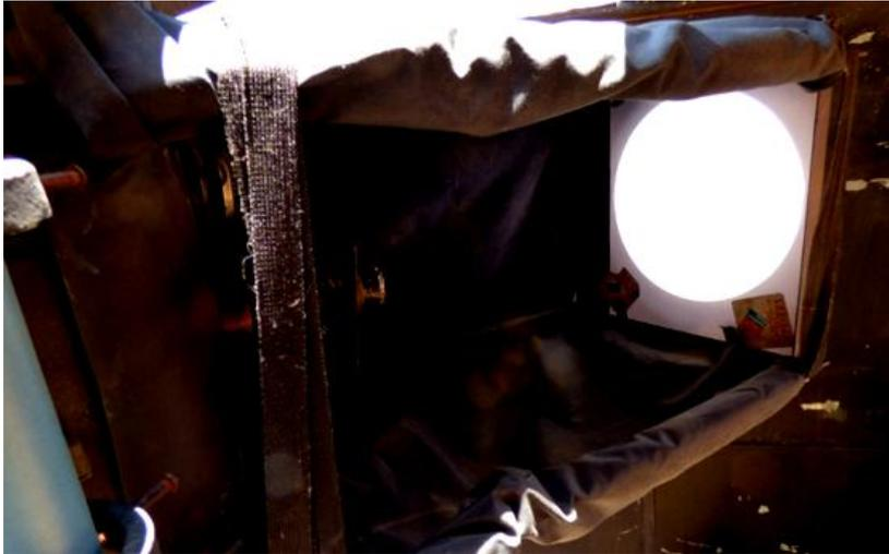
La pantalla de proyección para la imagen está cubierta de una tela que permite tener casi un cámara oscura para observar más nítidamente el detalle de las manchas solares.
