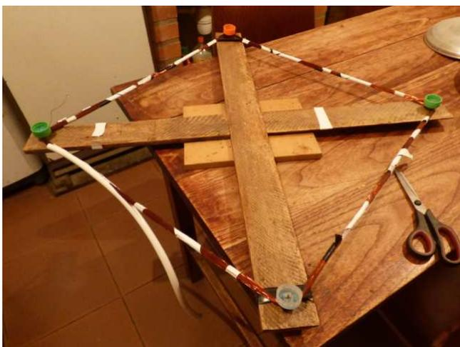
Esta es la antena loop o de cuadro fabricada con 140 vueltas de alambre aislado de cobre AWG 40. Esta bobina se protege del agua al estar dentro de una manguera de ducha que se cortó longitudinalmente, todas las ranuras se sellan con silicona. Esta antena tiene aproximadamente 0.0564 Henrios de impedancia y 42 ohms de resistencia.
