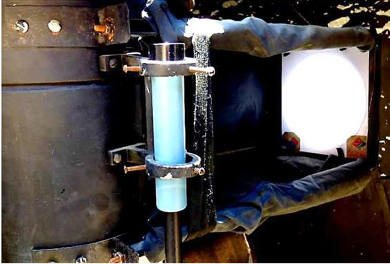
El método de observación es el de proyección de la imagen solar, usando para ello un telescopio reflector Newtoniano con espejo primario de 20 centímetros y una relación focal f/8. La imagen solar proyectada es de 25 centímetros en su diámetro.
