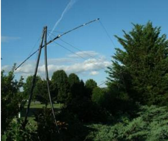
Aquí vemos parte del montaje de su antena Moxon que sirve para recibir señales del Sol en 20,1 MHz, usando un receptor JOVE.
