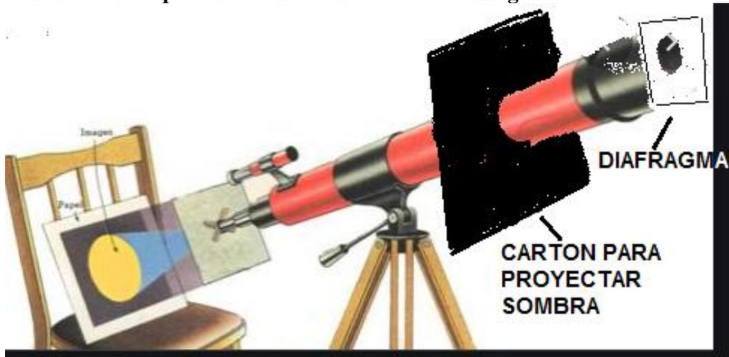
**Montaje de un telescopio refractor para observar manchas solares y eclipses de Sol.**
