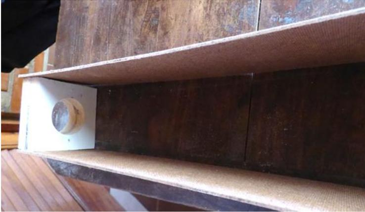
**Aqui vemos el soporte del tubo y los bujes para el movimiento en altura del telescopio. todo construido con madera aglomerada y tubos PVC.**
