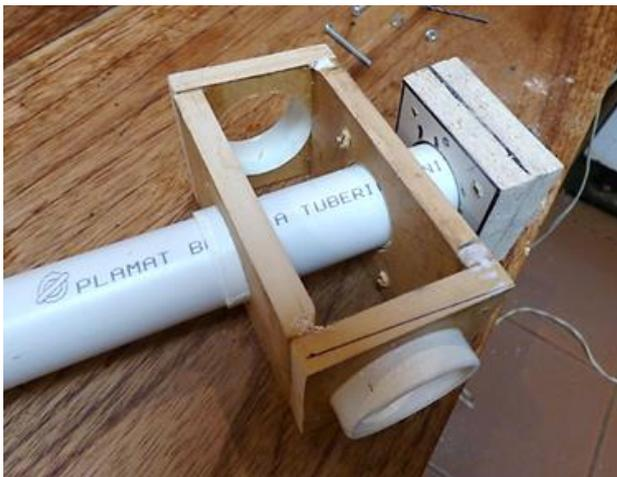
**Aqui se observa parte de la cámara de proyección de imagen solar. Esta caja o cámara permitirá observar la imagen solar reduciendo la interferencia de luz externa.**
