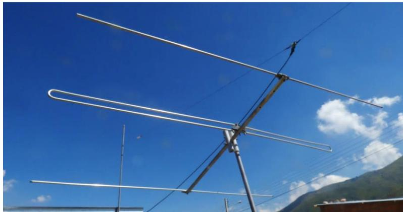
La radio sola no hace el trabajo se requiere la antena y ésta que aparece en pantalla es una antena con dipolo doblado, construida para la frecuencia de 73 MHz aproximadamente.
