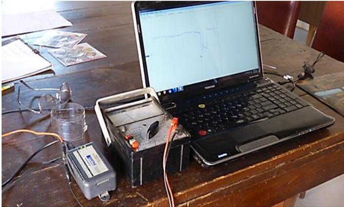
Así que monté lo necesario para realizar el experimento. En la imagen vemos un conversor de señal analógico a digital Data Q que convierte el nivel variable de corriente desde la fotocélula a señal digital que se introduce vía puerto USB a la computadora.
