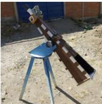
*El telescopio refractor RG (foto) tiene un objetivo de 35 mm y distancia focal de 750 mm. Con este instrumento tengo una imagen de 18.5 centímetros de diámetro (imagen proyectada) que me permite hacer dibujos diarios de las manchas solares. Actualmente con este instrumento realizo un trabajo para la Universidad de Stanford.*
