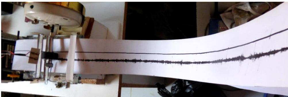
Este registrador totalmente analógico se basa en un modelo original diseñado por McWilliams de AAVSO en el año 1998. Básicamente es un variómetro de torsión.
