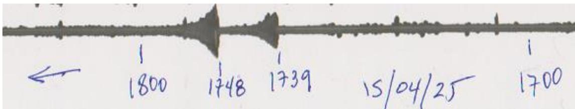
El registro corre de derecha a izquierda. El 15 de abril el nivel de amplitud de oscilación vertical fue de alrededor de 3 milímetros a las 17:00 T.U. Pero como se ve a las 17:39 se registró una súbita oscilación y aumento en la amplitud de la señal de 7 milímetros y nueve minutos. Más tarde otra perturbación mayor subió la amplitud a 10 milímetros y luego gradualmente fue desvaneciéndose.
